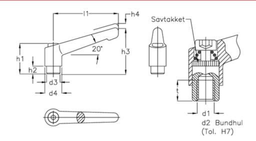
d1 = M10 Min hole depth = 14 d3 = 16 d4 = 21 h1 = 36 h2 = 8 h3 = 55 h4 = 4
